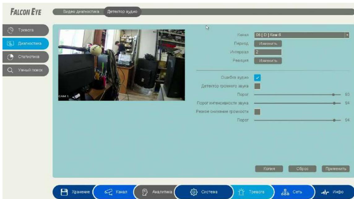
**Ошибка аудио** – включение режима при котором срабатывает тревога при нарушении аудио канала, например при обрыве питания микрофона.
