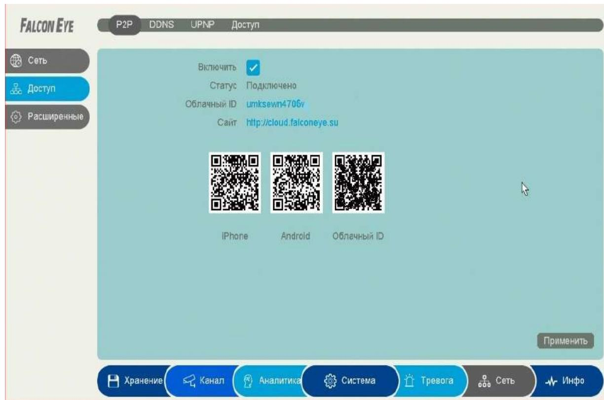
При включении этой функции видеорегистратор автоматически устанавливает соединение с сайтом <http://cloud.falconeye.su>. При этом не требуется никаких настроек роутера, связанных с пробросом портов и наличием выделенного IP адреса.
