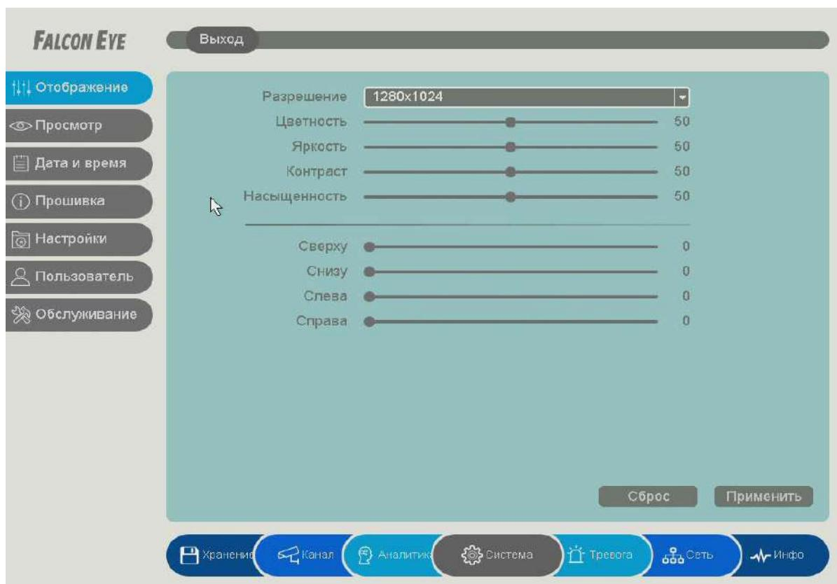
**Разрешение** – разрешение изображение на подключенном мониторе.
