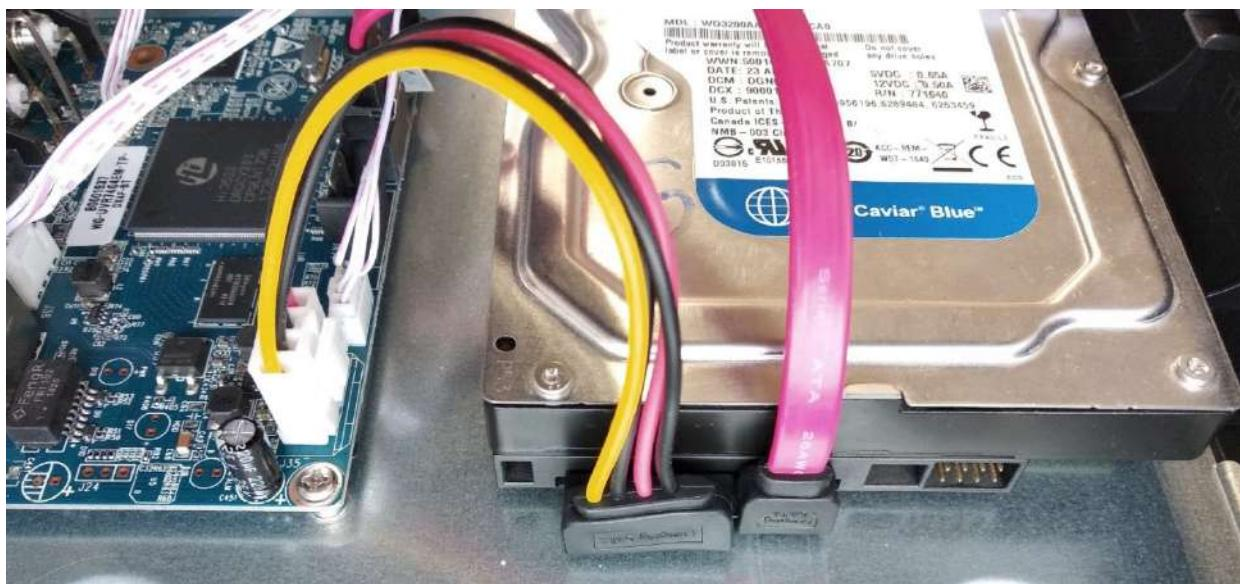
Подключите разъём кабеля питания и SATA кабель к соответствующим разъёмам HDD. Установите крышку и закрутите винты. Во избежание повреждения резьбы, не прикладывайте слишком много усилий при затяжке.
