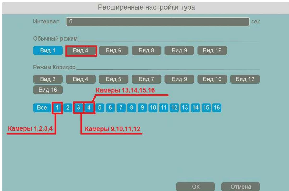
Для того, чтобы при включении тура отобразить нужную последовательность отображения камер, снимите галочки с ненужных видов и групп камер, оставьте активными только нужные виды и группы камер, нажмите **Применить**.
