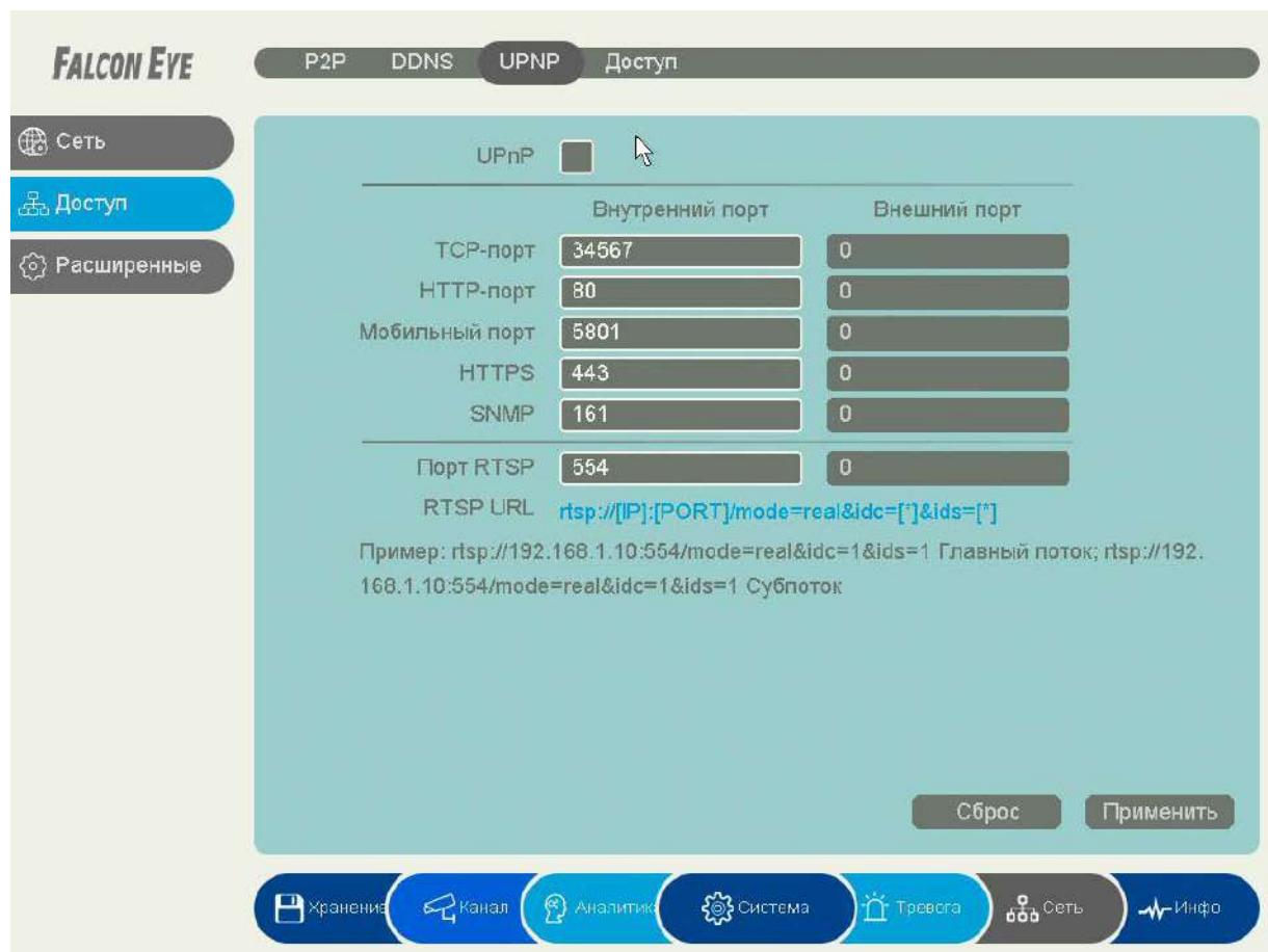
Если включено UPnP, то при поддержке данной функции маршрутизатором устройство автоматически транслирует порты через NAT маршрутизатора.
